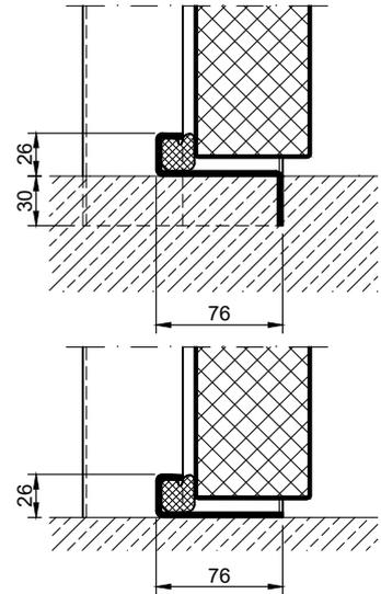
Anschlagsschwelle mit Dichtung
