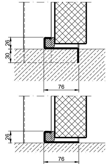
Anschlagsschwelle mit Dichtung
